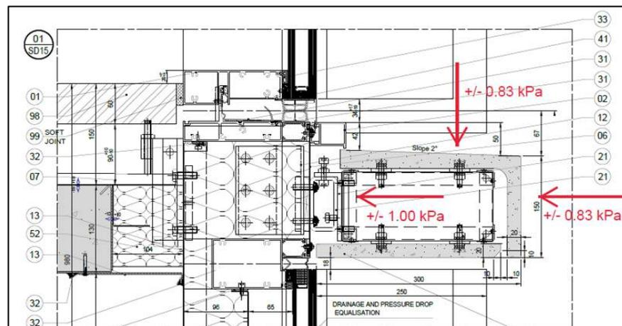
figura 5.30 - Dettaglio azione del vento agente sull'elemento di GFRC orizzontale
