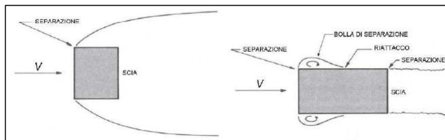
figura 1.8 - figura 2.21 CNR DT 207 - Separazione del flusso da corpi a spigoli vivi
