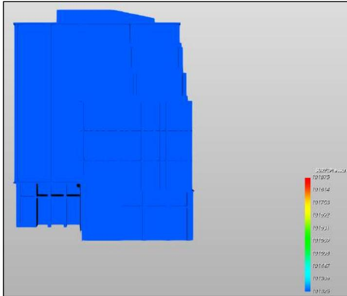
figura 4.38 -Andamento delle pressioni prospetto Est - caso 1 vento 0° (Nord)
