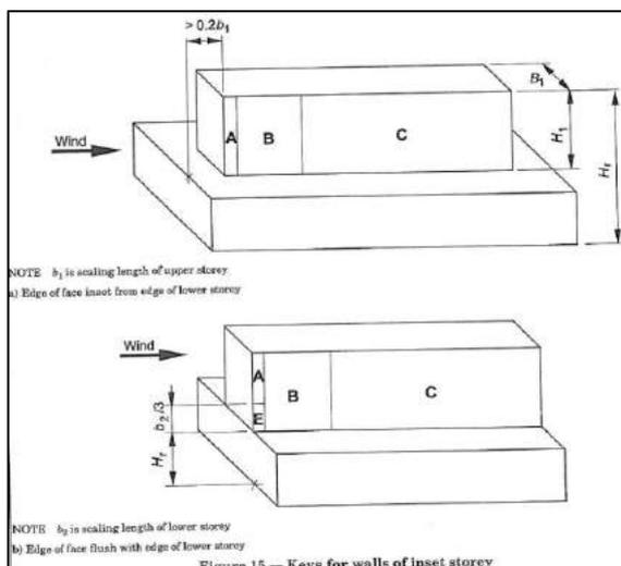
figura 2.34 – definizione delle zone per edificio con terrazzamenti – Figure 15 BS 6399-2:1997
