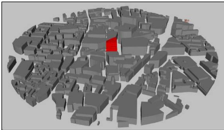
*figura 4.10 - Vista 3D Est modello CFD – VENTO AEC*
