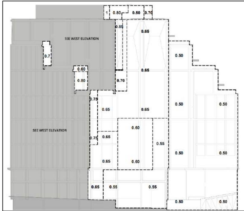
figura 4.45 – Pressioni negative di picco (kPa) – Prospetto Sud
