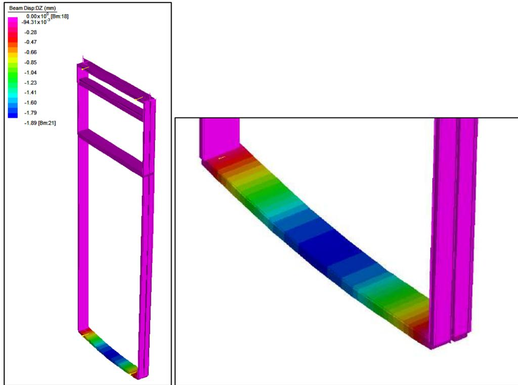
figura 5.27 - Deformazione direzione z - combinazione SLS 6 – approccio normative
