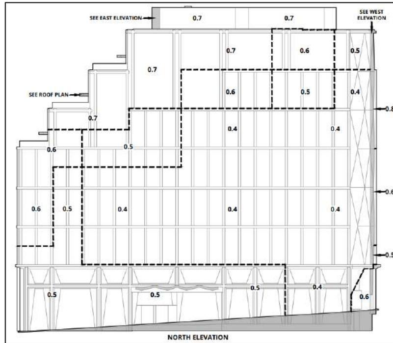
figura 3.20 – Pressioni positive di picco – Prospetto Nord
