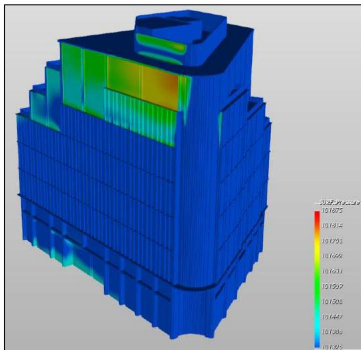
figura 4.33 - Andamento delle pressioni vista 3D Nord Ovest - caso 1 vento  $0^\circ$  (Nord)
