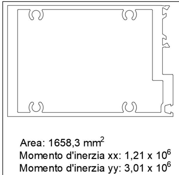
figura 5.19 - Sezione trasverso intermedio superiore - approccio normative
