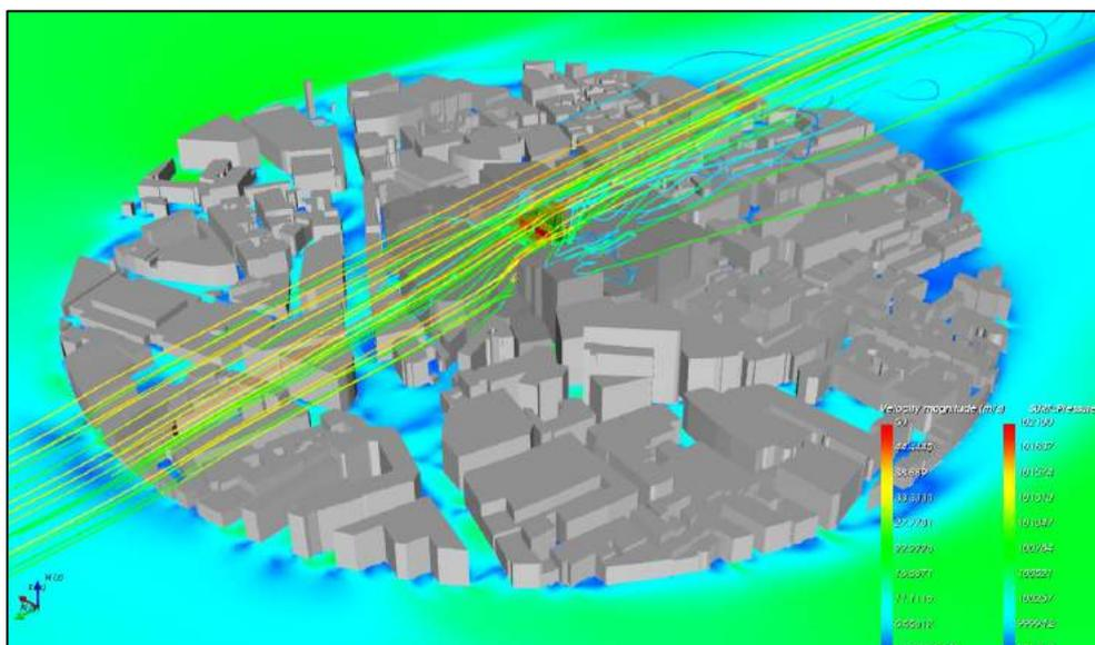
figura 5.5 - Andamento del flusso eolico nei pressi di Stonecutter Court Building – caso 1 vento 0°
