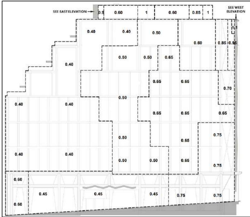
figura 4.43 – Pressioni negative di picco (kPa) – Prospetto Nord
