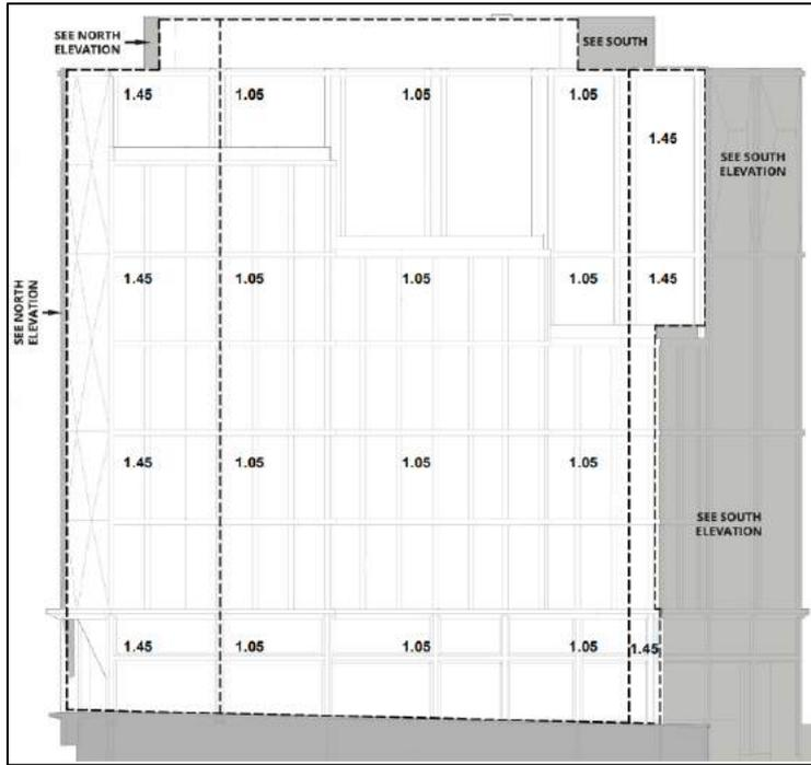
figura 2.40 - Pressioni negative di picco (kPa) – Prospetto Ovest
