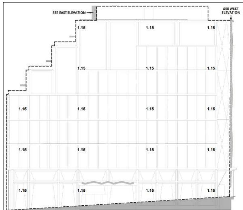
figura 2.43 - Pressioni positive di picco (kPa) – Prospetto Nord
