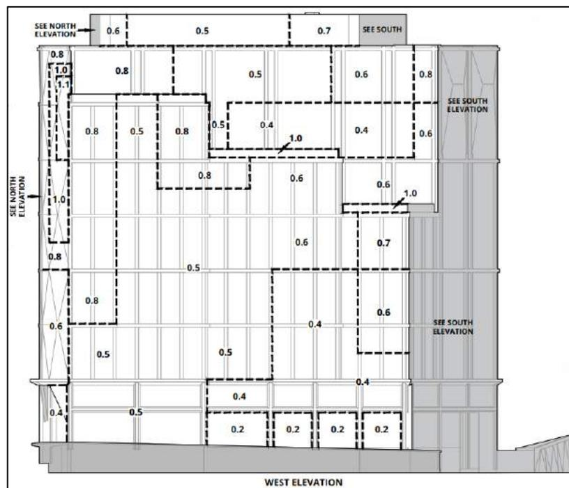
figura 3.17 – Pressioni negative di picco (kPa) – Prospetto ovest
