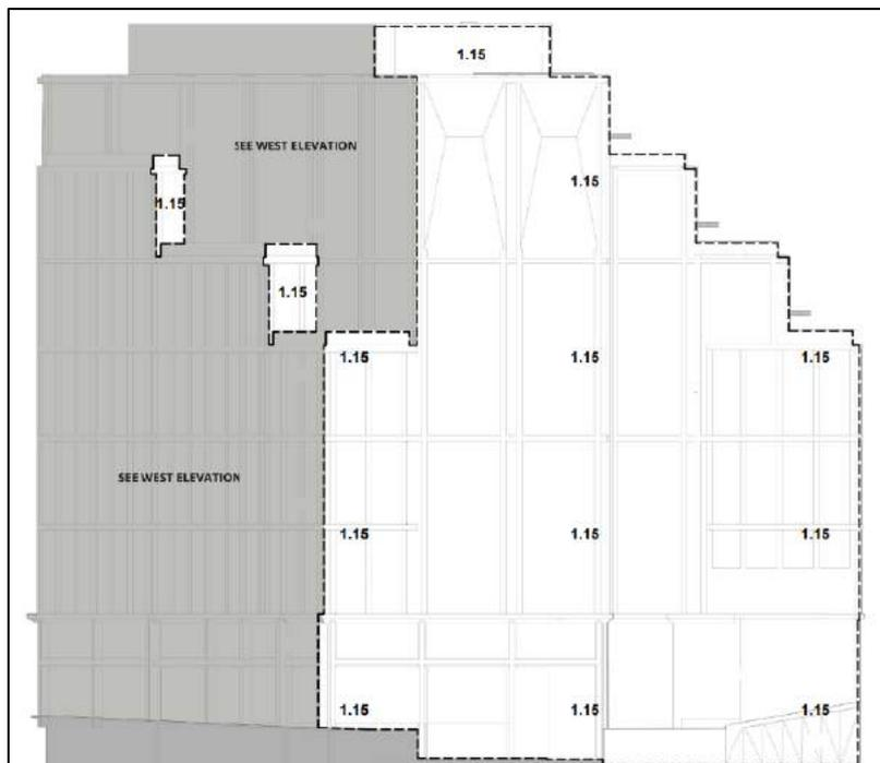
figura 2.45 - Pressioni positive di picco (kPa) – Prospetto Sud
