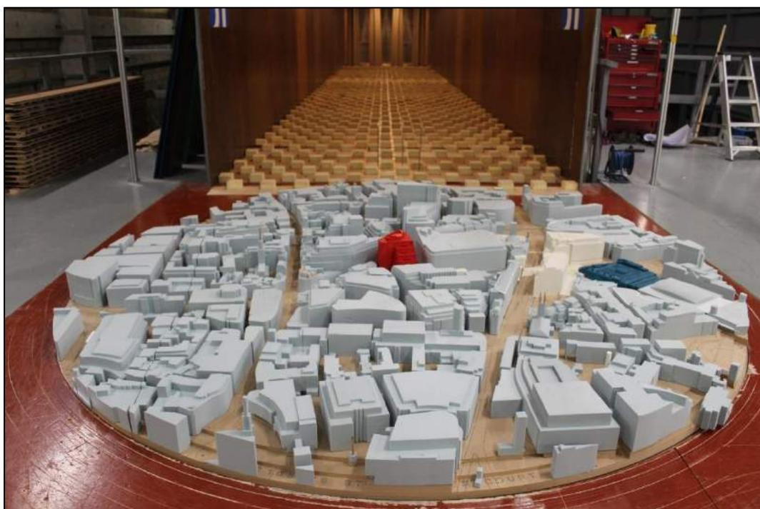
*figura 3.7 – Modello analisi in galleria del vento in scala 1:300 – vista Est*
