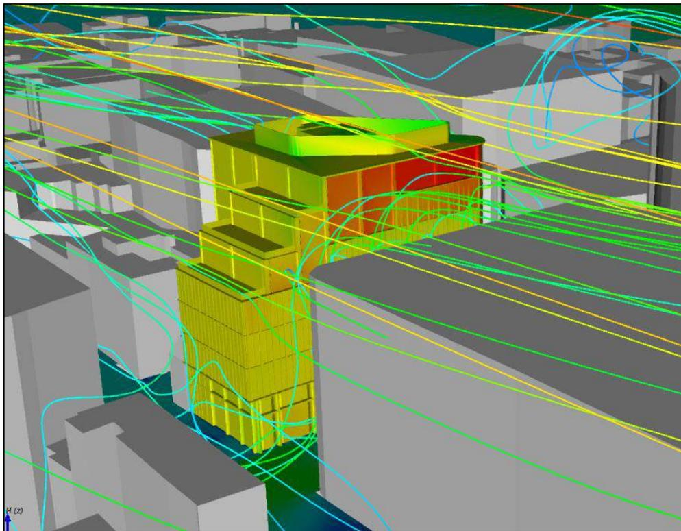
figura 5.7– Dettaglio andamento del flusso eolico nei pressi di Stonecutter Court Building – caso 1 vento  $0^\circ$
