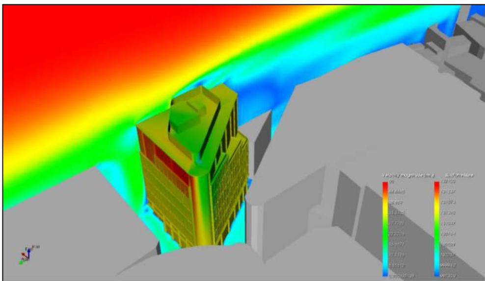
figura 5.2 – Dettaglio velocità del flusso eolico sul piano  $xy$  ( $z=0m$ ) e sul piano  $yz$  ( $x=0m$ ) – caso 1 vento  $0^\circ$
