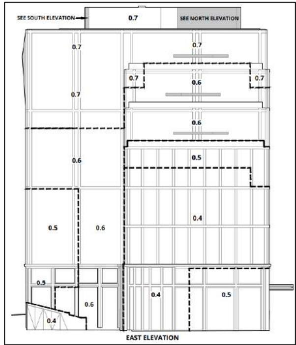
figura 3.23 – Pressioni positive di picco – Prospetto Est
