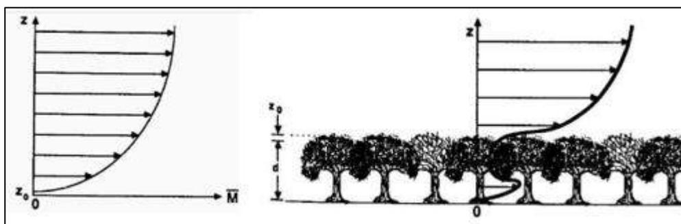
figura 1.3 - Profilo logaritmico della velocità in campo aperto ed in presenza di un bosco
