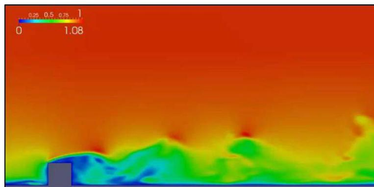
figura 1.11 - Variazioni di velocità in vicinanza di un edificio singolo
