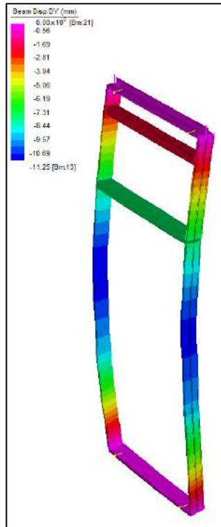
figura 5.38 – Deformazione direzione y – combinazione SLS 1 – approccio alternativo
