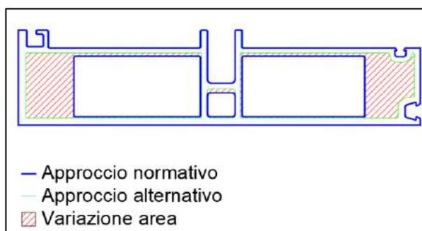
figura 5.43 - Variazione di sezione – Montante
