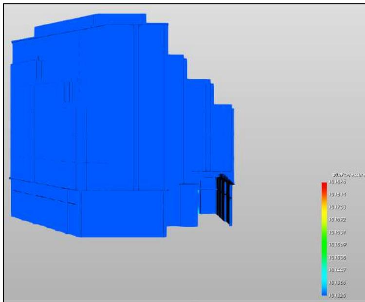
figura 4.37 - Andamento delle pressioni prospetto Est - caso 1 vento 0° (Nord)
