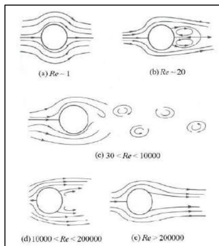
figura 1.7 - figura 2.20 CNR DT 207 - Flusso cilindro di infinita lunghezza
