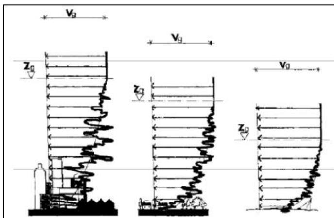
figura 1.2 - Profilo della velocità del vento al variare della rugosità del terreno – CNR DT207
