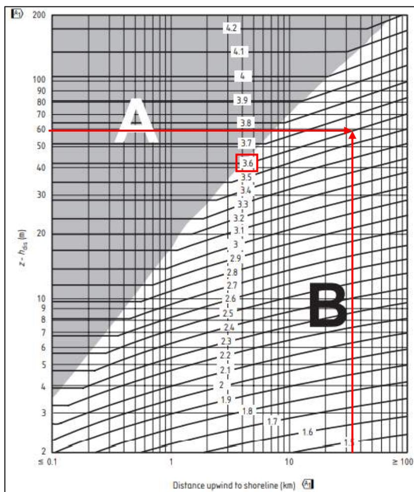
figura 2.20 - Coefficiente di esposizione  $C_e$  - Figure NA.7 National Annex to BS EN 1991-1-4
