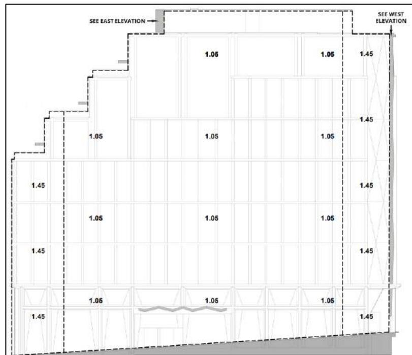
figura 2.39 - Pressioni negative di picco (kPa) – Prospetto Nord
