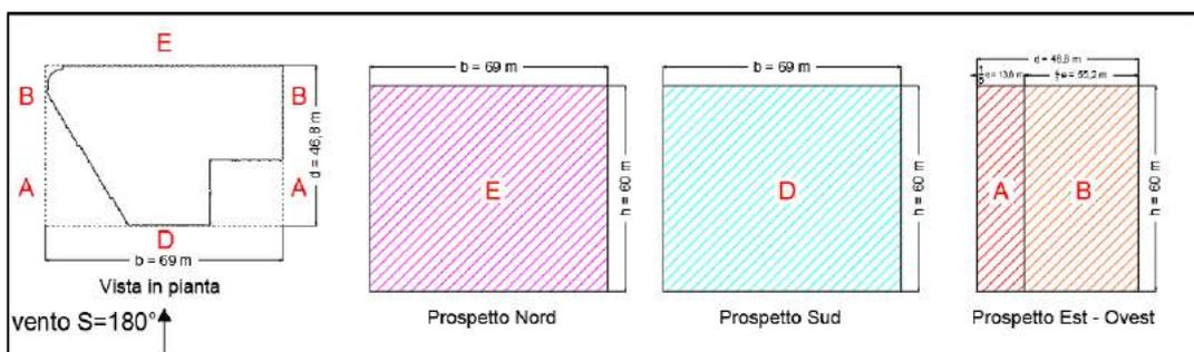
figura 2.30 – Zone di pressione edificio schematizzato di forma rettangolare – direzione del vento  $180^\circ$
