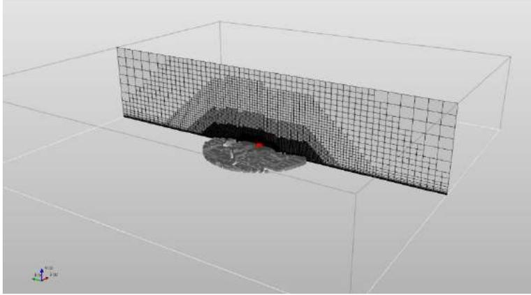
*figura 4.24 – mesh zy (direzione del flusso eolico) a  $x = 0$*
