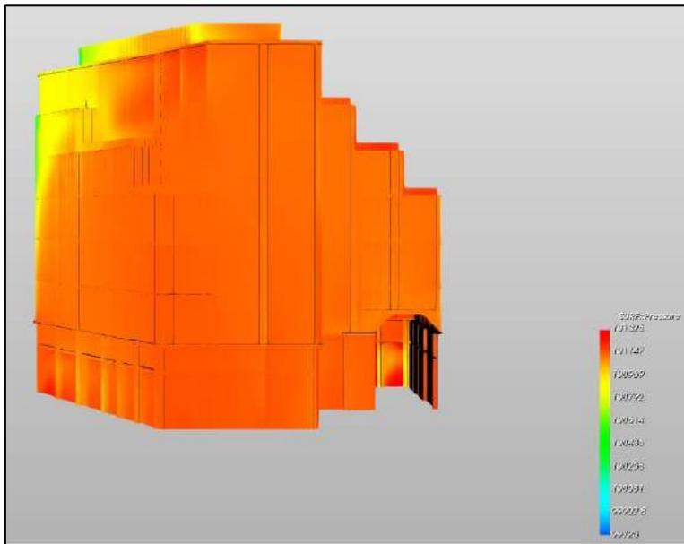
figura 4.41 - Andamento delle depressioni prospetto Sud - caso 1 vento 0° (Nord)
