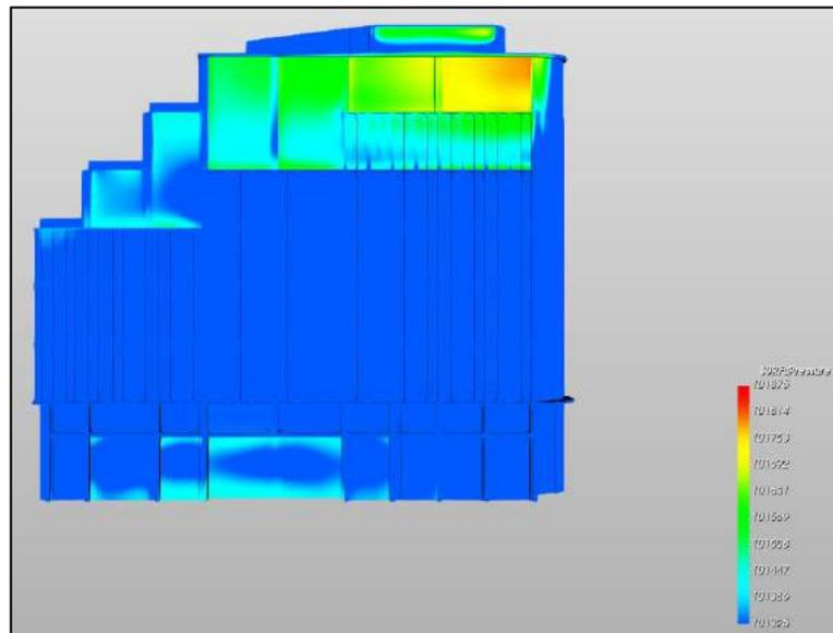
figura 4.35 - Andamento delle pressioni prospetto Nord - caso 1 vento 0° (Nord)
