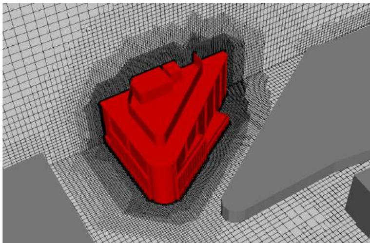
*figura 4.29 - Dettaglio mesh xyz a quota  $z = 0\text{ m}$*
