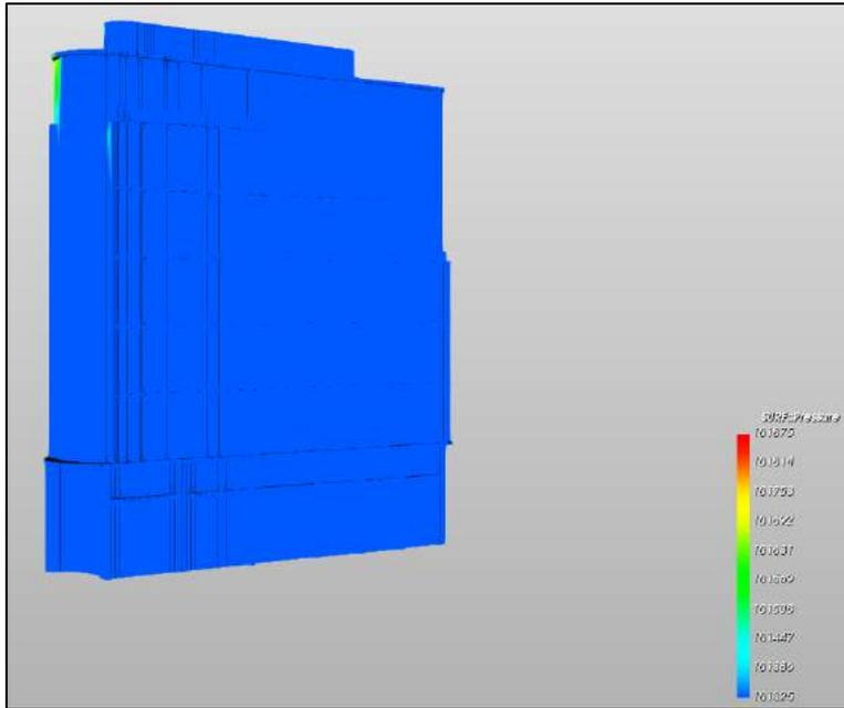
figura 4.36 - Andamento delle pressioni prospetto Ovest - caso 1 vento 0° (Nord)
