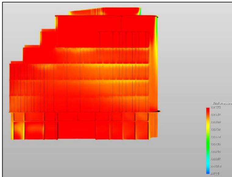
figura 4.39 - Andamento delle depressioni prospetto Nord - caso 1 vento 0° (Nord)
