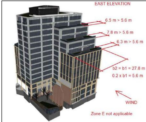
figura 2.36 - Prospetto Est - direzione del vento Est-Ovest
