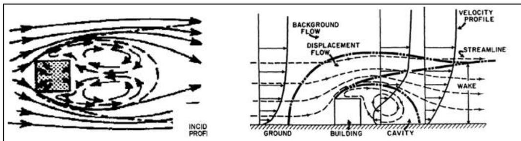
figura 1.10 - Variazioni del flusso d'aria in vicinanza di un edificio singolo
