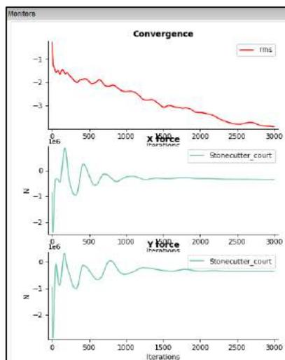
figura 4.32 - Esempio di convergenza matematica e ingegneristica
