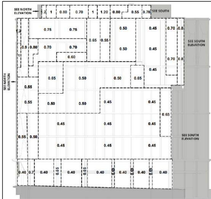
figura 4.44 – Pressioni negative di picco (kPa) – Prospetto Ovest
