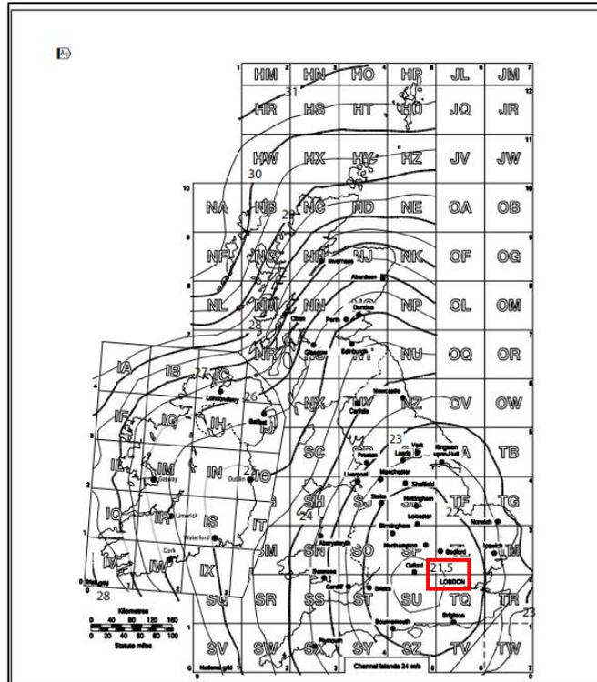
figura 2.17 - Valore della velocità base del vento - Figure NA.1 (UK NA)
