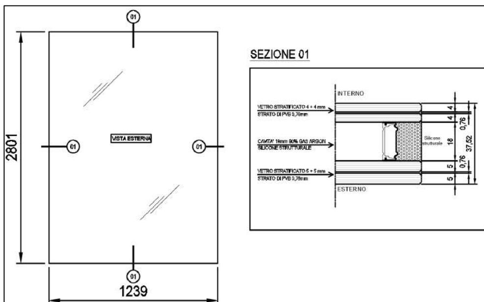
figura 5.63 – Vista esterna e sezione vetro-camera - approccio alternativo
