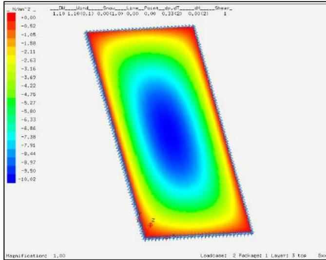
figura 5.66– Mappatura delle tensioni vetro 1 pannello esterno combinazione ULS 2 – Mepla - Approccio alternativo
