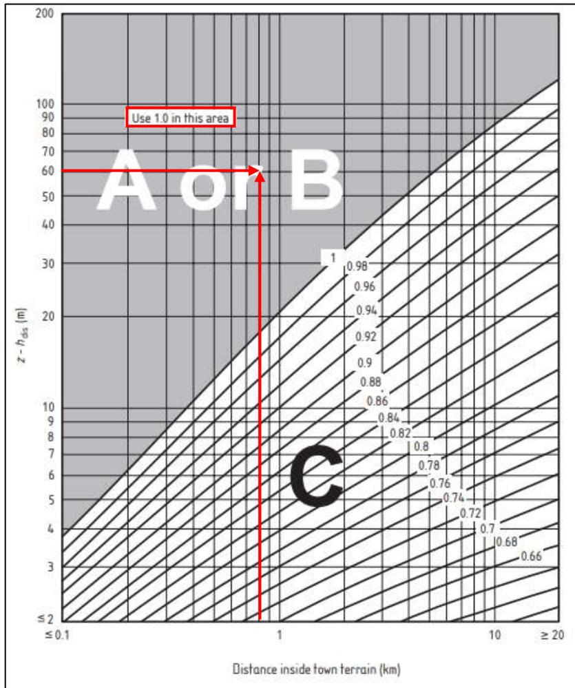
figura 2.21 – Coefficiente correttivo di esposizione  $C_{e,T}$  - Figure NA.8 National Annex to BS EN 1991-1-4
