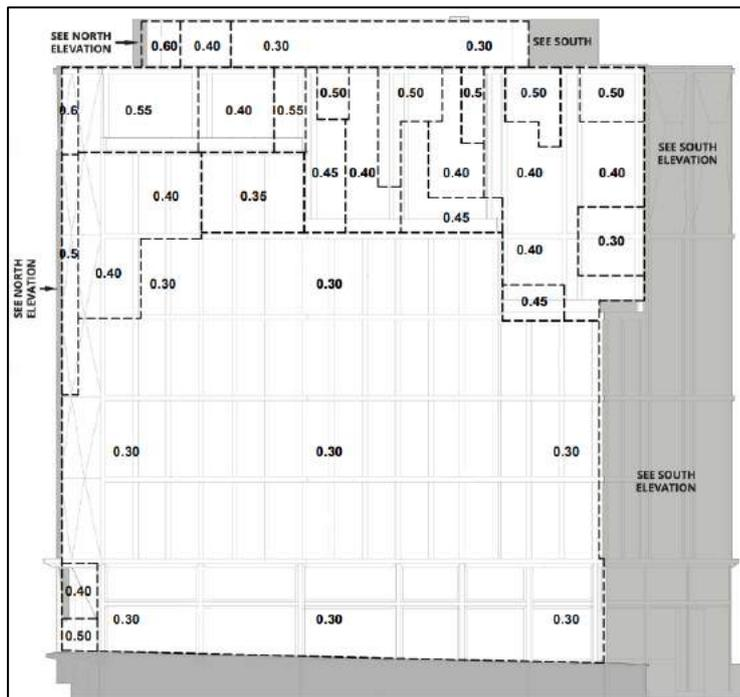
figura 4.48 – Pressioni positive di picco (kPa) – Prospetto Ovest
