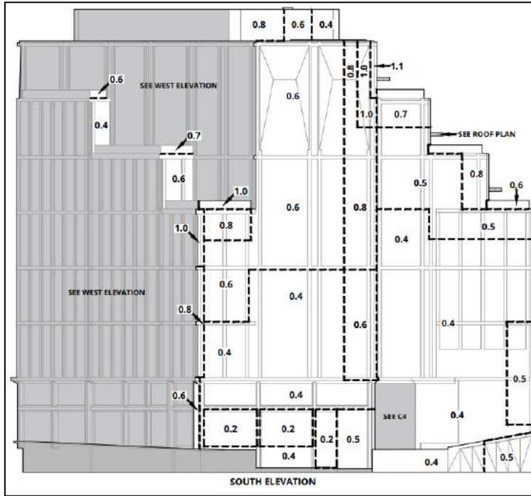
figura 3.18 – Pressioni negative di picco – Prospetto Sud
