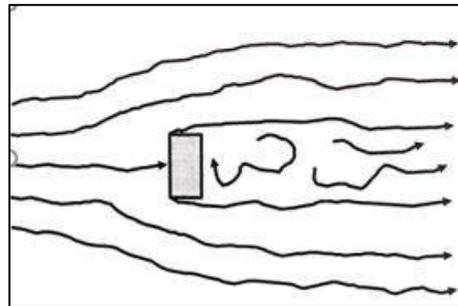
figura 3.2 - Andamento del flusso eolico in ambiente teoricamente infinito (caso reale)
