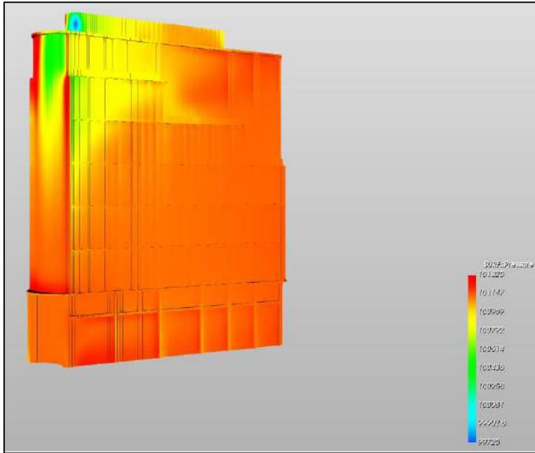
figura 4.40 - Andamento delle depressioni prospetto Ovest - caso 1 vento 0° (Nord)
