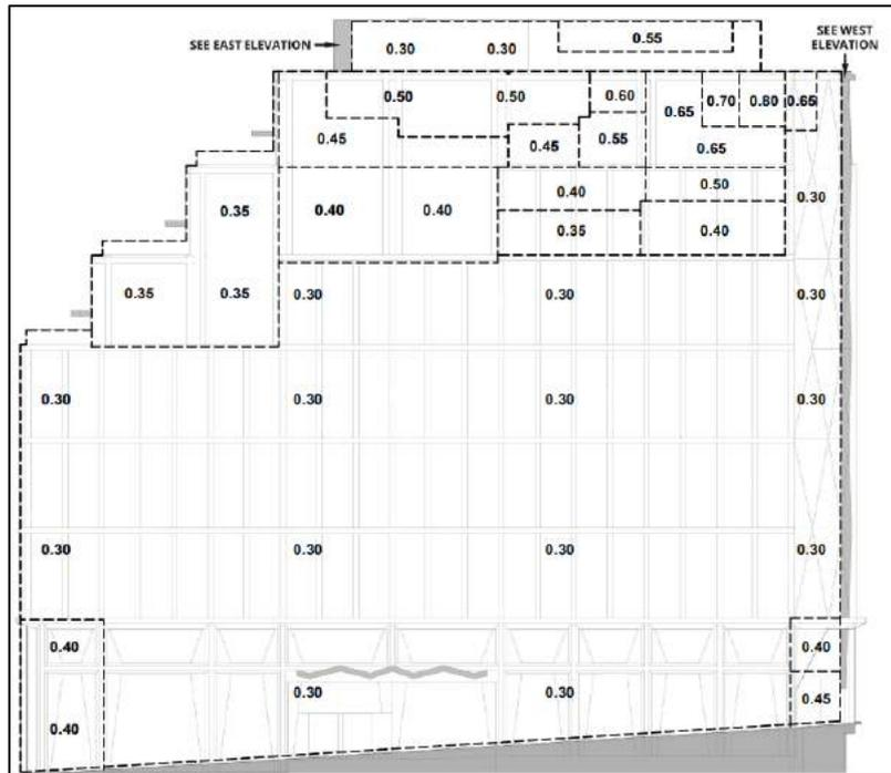
figura 4.47 – Pressioni positive di picco (kPa) – Prospetto Nord
