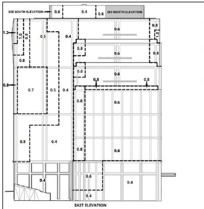
figura 3.19 – Pressioni negative di picco – Prospetto Est
