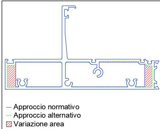
figura 5.44 - Variazione di sezione - Traverso maschio
