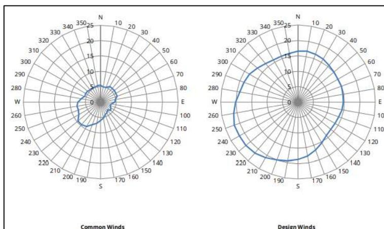
figura 3.11 –Velocità del vento comuni (sx) e di Progetto (dx) al variare della direzione
