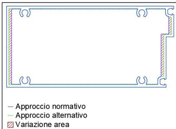
figura 5.46 - Variazione di sezione - Traverso intermedio inferior
