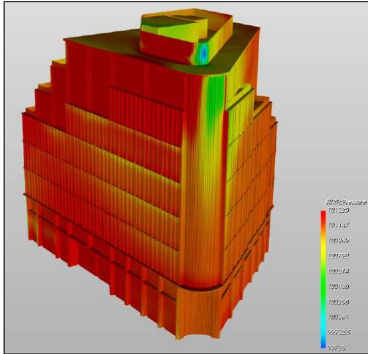
figura 4.34 - Andamento delle pressioni vista 3D Nord Ovest - caso 1 vento 0° (Nord)
