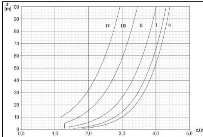
figura 2.23 – Andamento del coefficiente di esposizione – Figure 4.2 UNI EN 1991-1-4:2005
