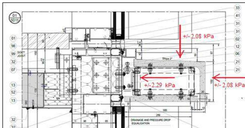
figura 5.11 – Dettaglio azione del vento agente sull'elemento di GFRC orizzontale
