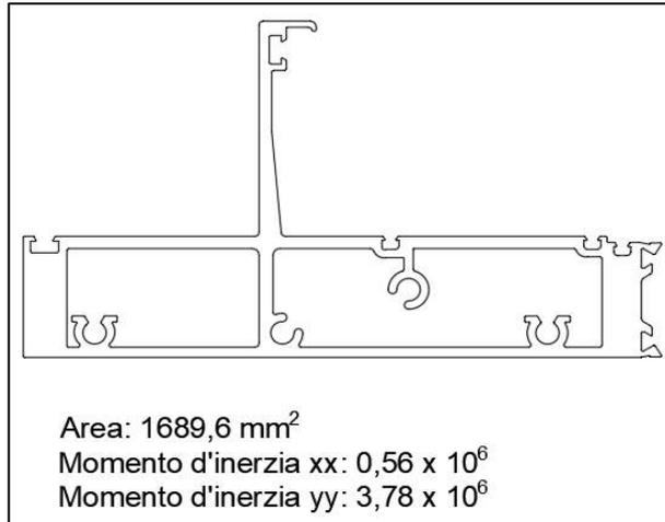
figura 5.16 - Sezione trasverso maschio - approccio normative
