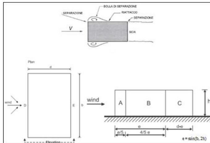
Figura 2.25 - Relazione tra comportamento di un edificio soggetto all'azione del vento e divisione in zone
