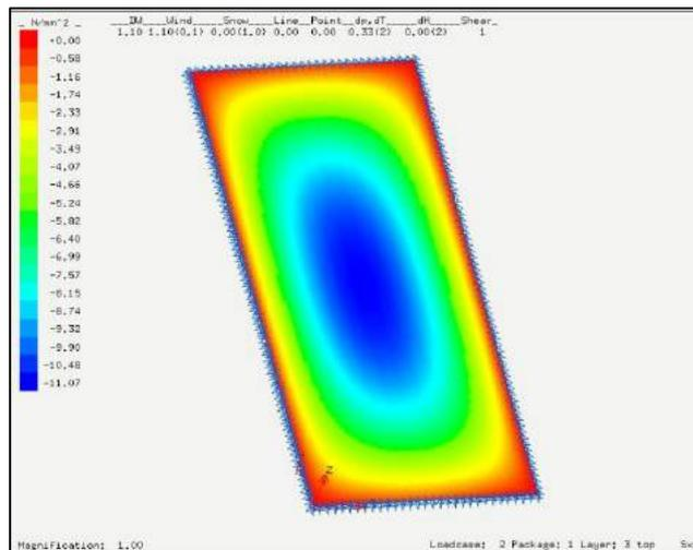
figura 5.62 – Mappatura delle tensioni vetro 1 pannello esterno combinazione ULS 2 – Mepla- Approccio normativo
