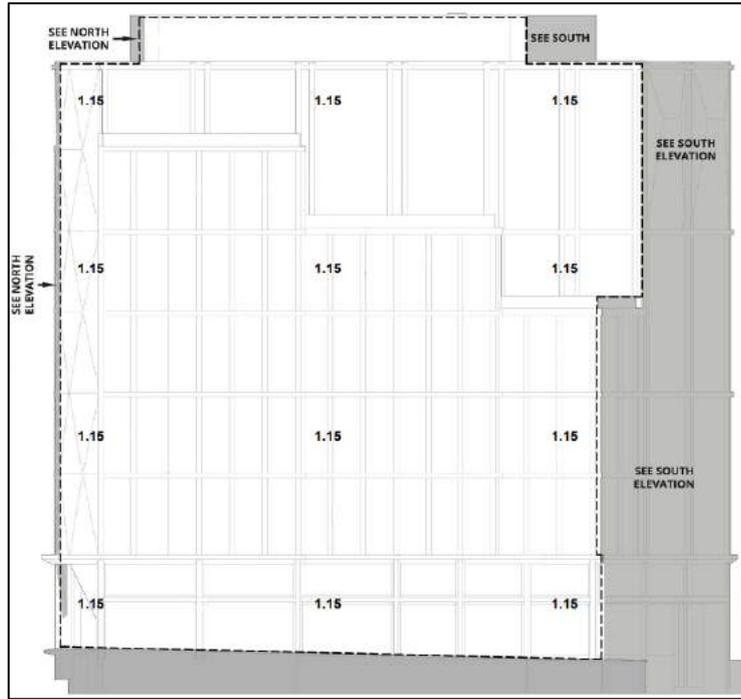
figura 2.44 - Pressioni positive di picco (kPa) – Prospetto Ovest
