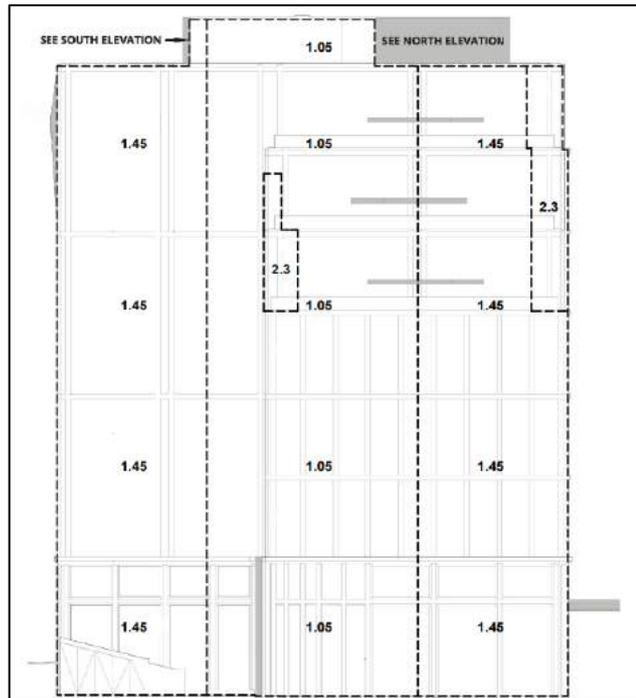
figura 2.42 - Pressioni negative di picco (kPa) – Prospetto Est
