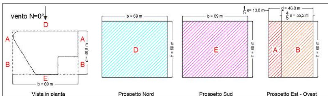
figura 2.28 – Zone di pressione edificio schematizzato di forma rettangolare – direzione del vento  $0^\circ$
