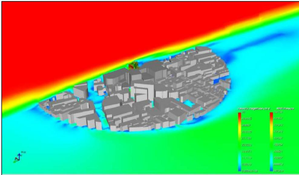
figura 5.1 – Velocità del flusso eolico sul piano  $xy$  ( $z=0m$ ) e sul piano  $yz$  ( $x=0m$ ) – caso 1 vento  $0^\circ$
