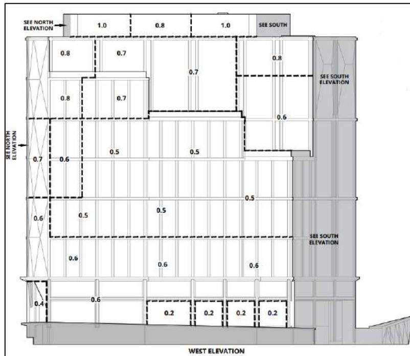
figura 3.21 – Pressioni positive di picco – Prospetto Ovest
