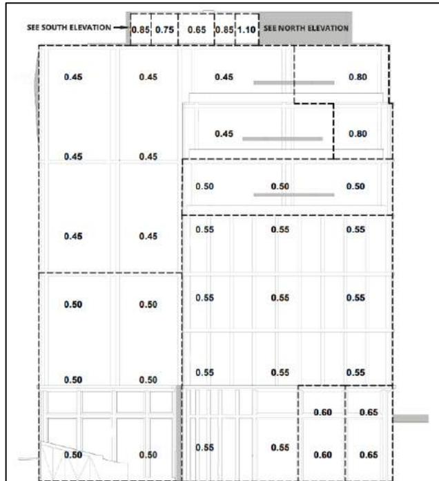
figura 4.46 – Pressioni negative di picco (kPa) – Prospetto Est
