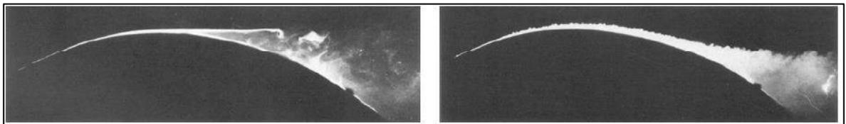
figura 1.6 - Figura2.19 CNR DT 207 - Strato limite laminare (sx) e turbolento (dx)
