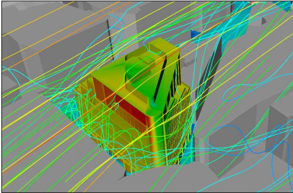
figura 5.6 – Dettaglio andamento del flusso eolico nei pressi di Stonecutter Court Building – caso 1 vento  $0^\circ$
