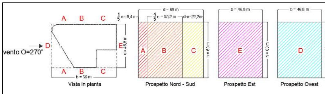
figura 2.31 – Zone di pressione edificio schematizzato di forma rettangolare – direzione del vento 270°
