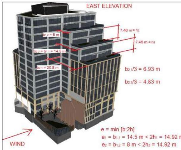
figura 2.37 - Prospetto Est - direzione del vento Sud Nord
