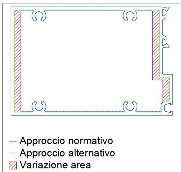
figura 5.47 - Variazione di sezione - Traverso intermedio superiore
