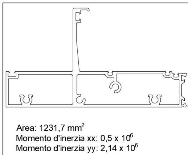
*figura 5.32 - Sezione trasverso maschio - Approccio alternativo*
