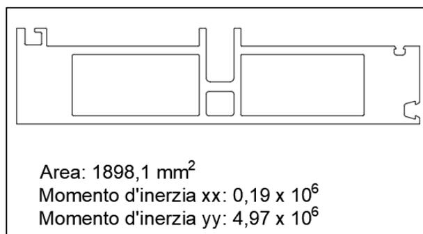
figura 5.15 - Sezione montante - approccio normative
