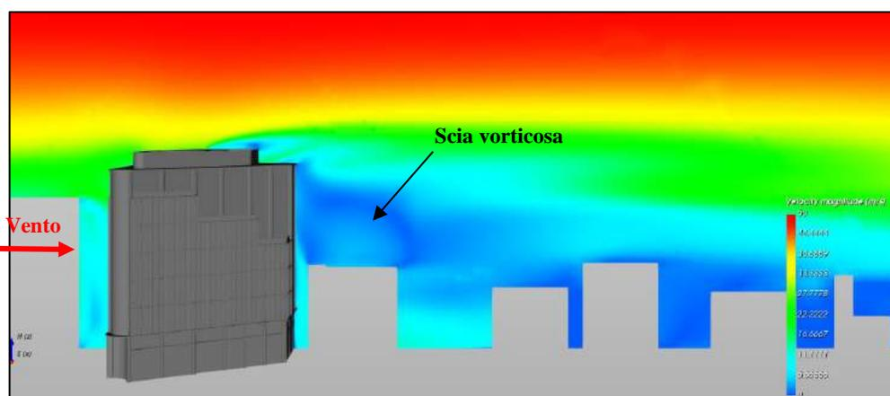
figura 5.4 – Dettaglio velocità del flusso eolico sul piano sul piano  $yz$  ( $x=0m$ ) – caso 1 vento  $0^\circ$
