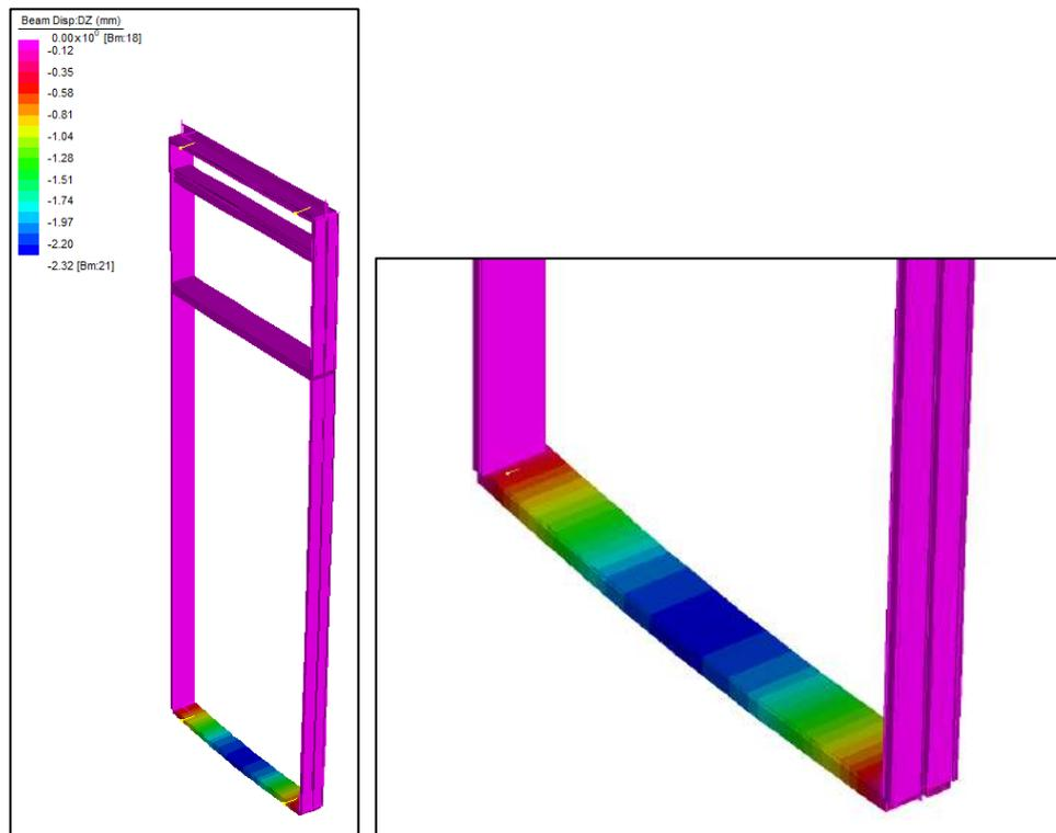
figura 5.39 - Deformazione direzione z - combinazione SLS 6 – approccio alternativo
