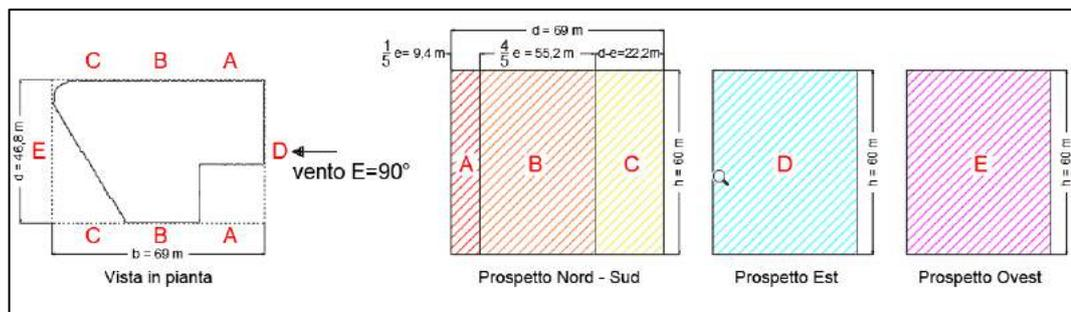
figura 2.29 – Zone di pressione edificio schematizzato di forma rettangolare – direzione del vento  $90^\circ$
