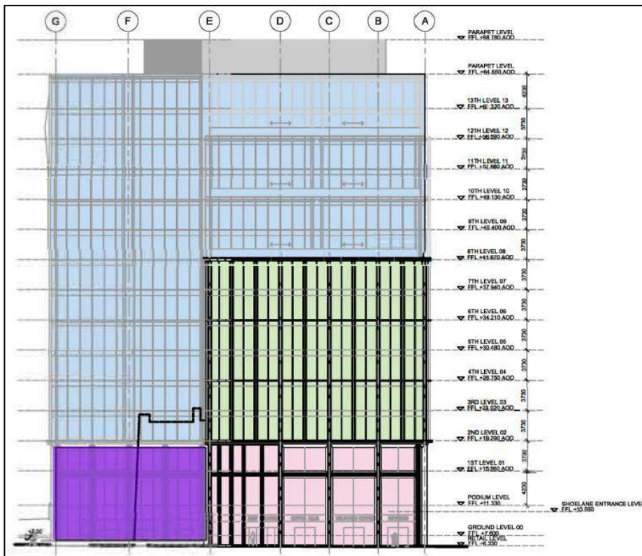
figura 2.15 - Tipologie facciate - Prospetto Est
