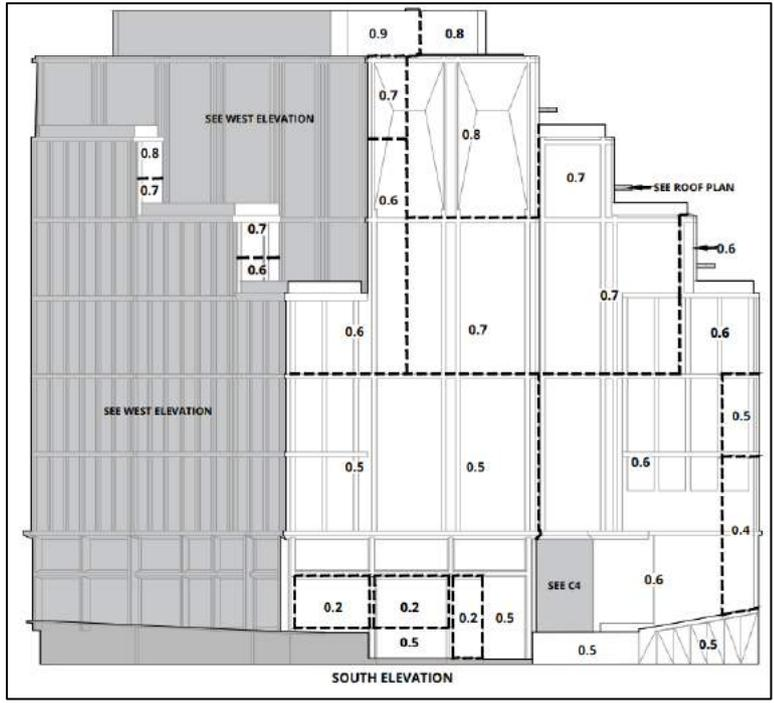
figura 3.22 – Pressioni positive di picco – Prospetto Sud
