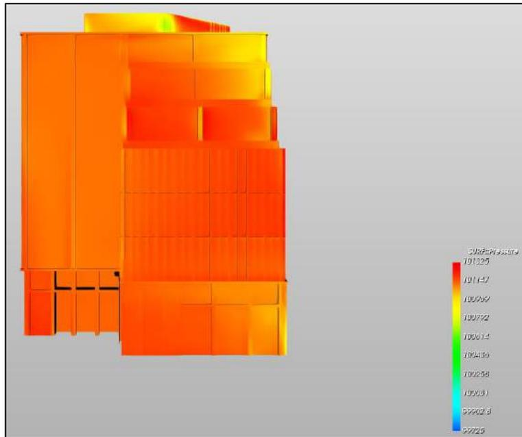
figura 4.42 - Andamento delle depressioni prospetto Est - caso 1 vento 0° (Nord)
