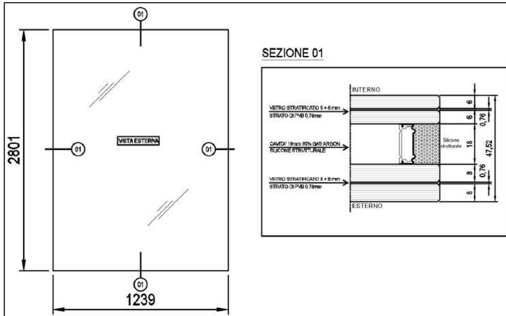
figura 5.52 – Vista esterna e sezione vetro-camera - approccio normative
