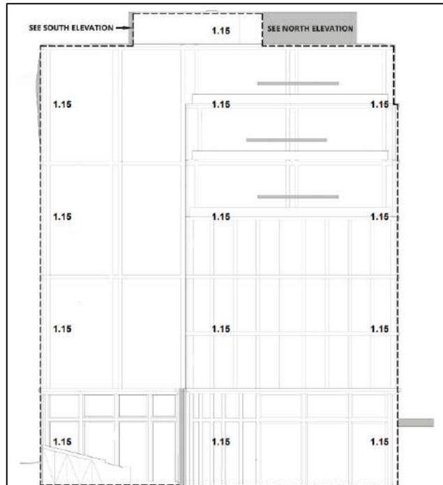
figura 2.46 - Pressioni positive di picco (kPa) – Prospetto Est
