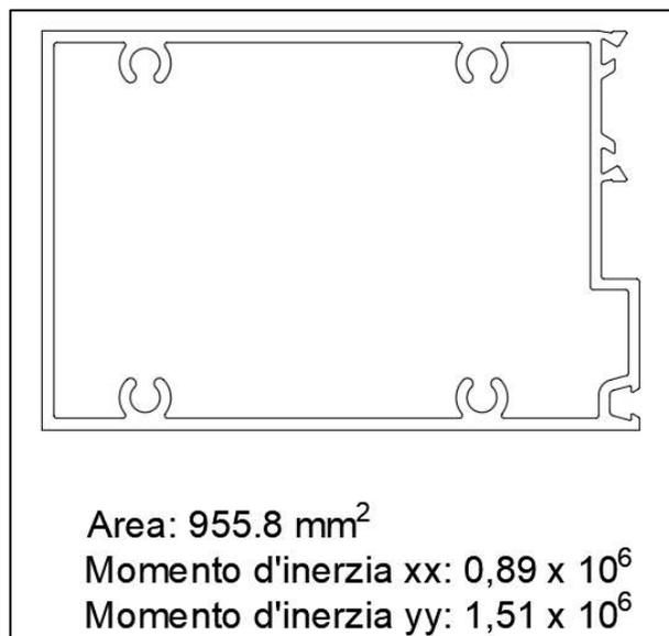
*figura 5.35 - Sezione trasverso intermedio superiore - Approccio alternativo*
