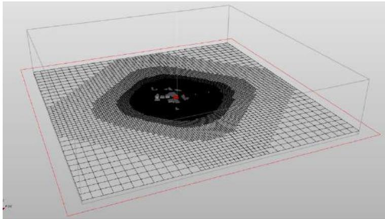
*figura 4.22 – mesh xy a quota  $z = 40$  m*
