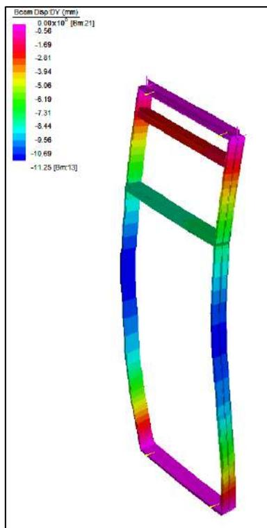
figura 5.26 – Deformazione direzione y – combinazione SLS 1 – approccio normative
