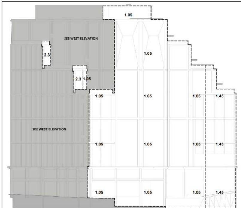
figura 2.41 - Pressioni negative di picco (kPa) – Prospetto Sud
