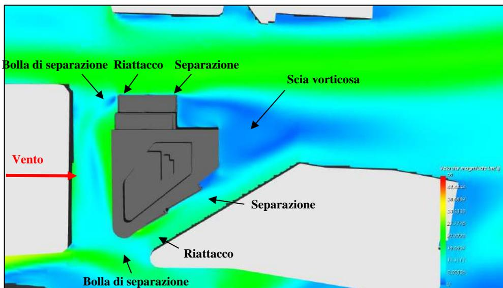
figura 5.3 – Dettaglio velocità del flusso eolico sul piano  $xy$  ( $z=30m$ ) – caso 1 vento  $0^\circ$
