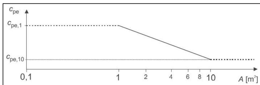
figura 2.24 – Andamento del Coefficiente  $C_{pe}$  – Figure 7.2 UNI EN 1991-1-4:2005
