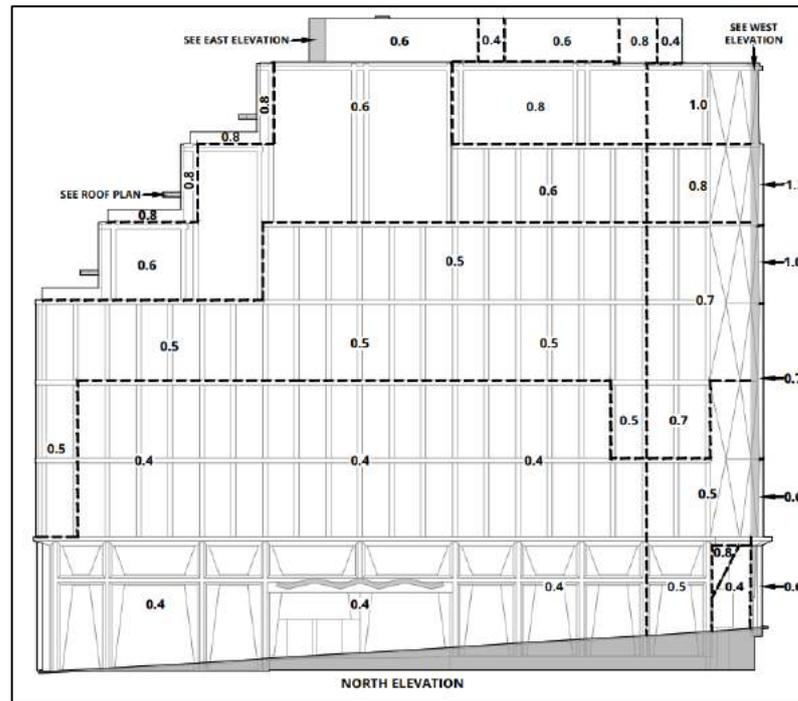
figura 3.16 – Pressioni negative di picco (kPa) – Prospetto Nord
