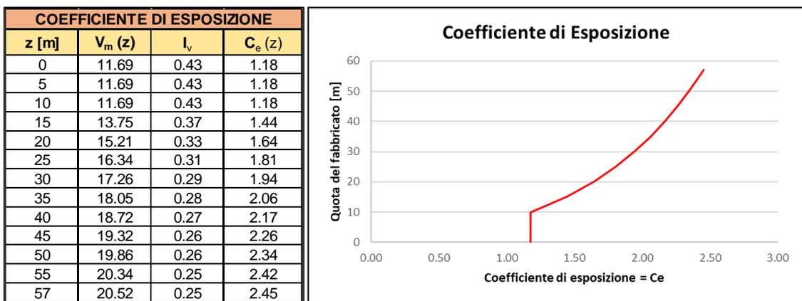
figura 2.22 - Andamento del coefficiente di esposizione al variare di quota
