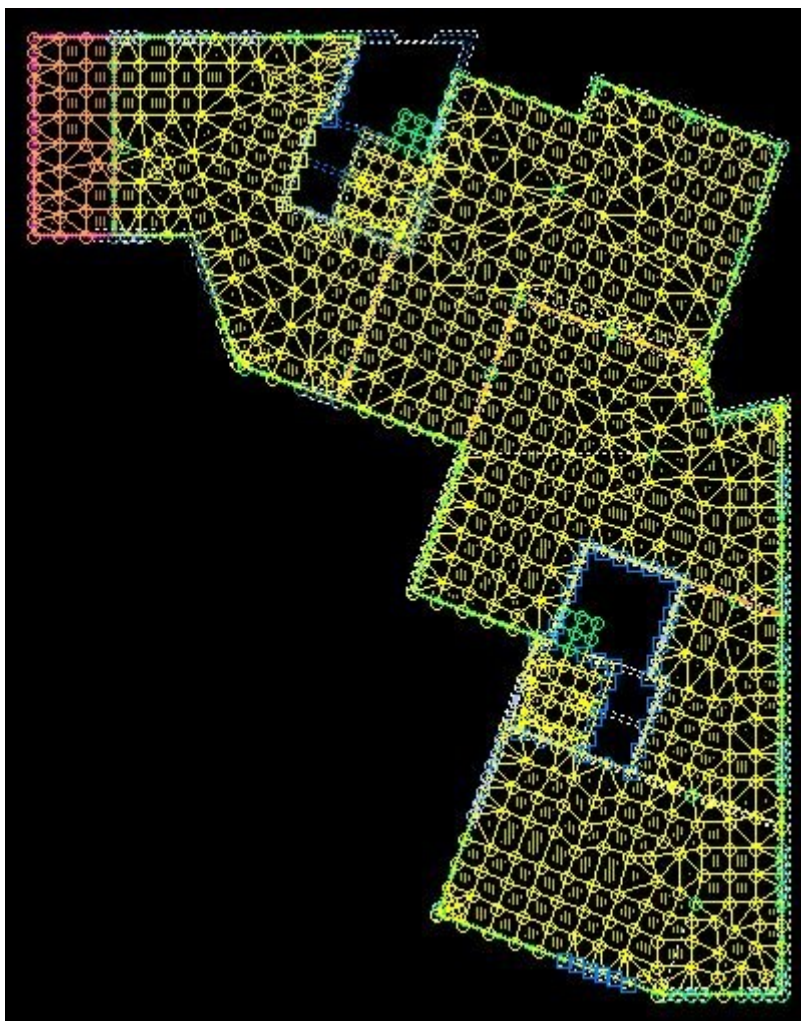
Figura 75: Impalcato del 3° piano modellato in CDM DOLMEN.
