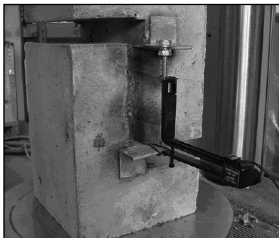
Figura 5.2-3: Set-up della prova a taglio diretto
