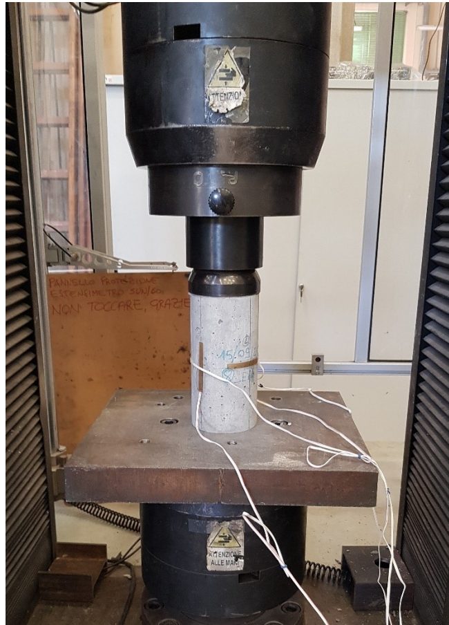
Figura 6.6-8: Setup della prova a compressione ciclica
