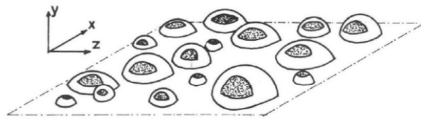
Figura 3.3-5: Area di contatto degli aggregati durante uno scorrimento a taglio
