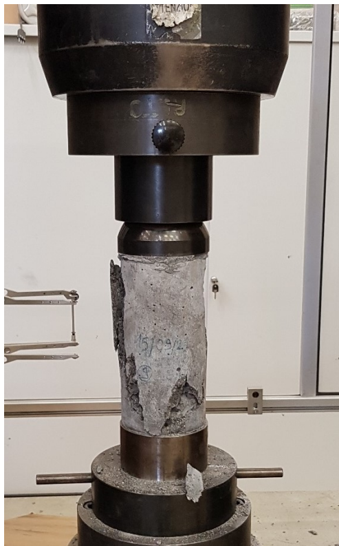
Figura 7.1-5: Configurazione di rottura del provino 9_EAF dopo la prova a compressione a 56 giorni
