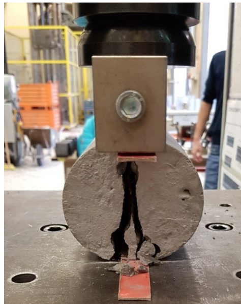
Figura 7.2-3: Configurazione di rottura del provino 6_REF dal retro della macchina al termine dello splitting test
