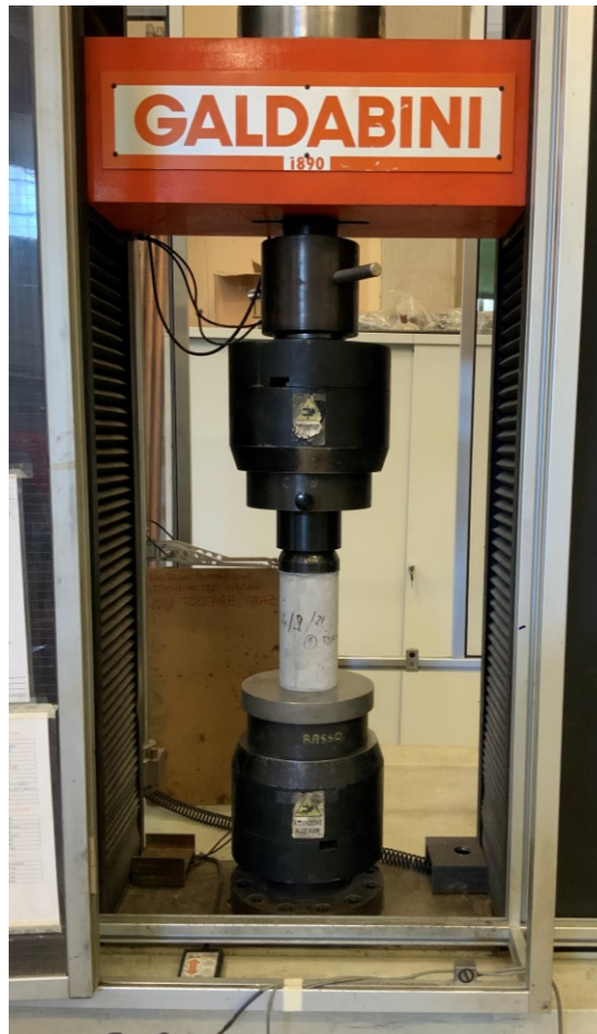
Figura 6.6-1: Set up della prova a compressione monotona
