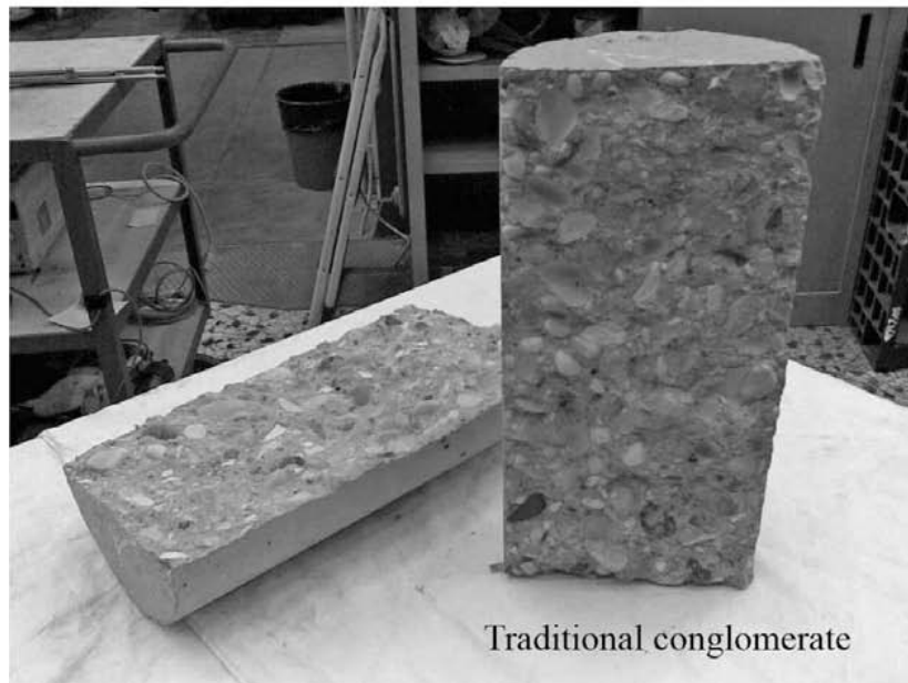
Figura 2.5-3: Confronto tra un calcestruzzo di scorie e un calcestruzzo di tipo tradizionale
