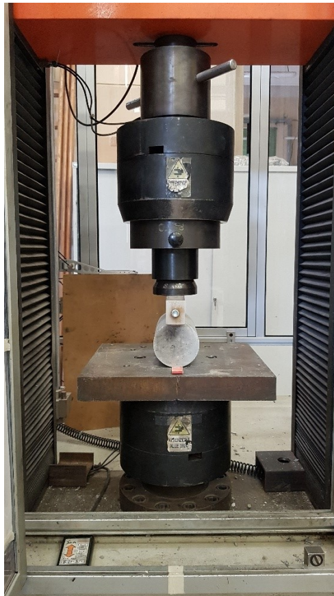
Figura 6.6-4: Setup della prova a trazione indiretta
