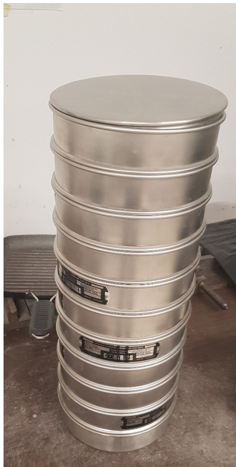
Figura 6.1-2: La colonna di setacci pronta per la vagliatura, in questo caso eseguita in maniera manuale
