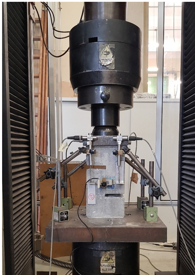
Figura 6.6-5: Setup della prova a taglio diretto
