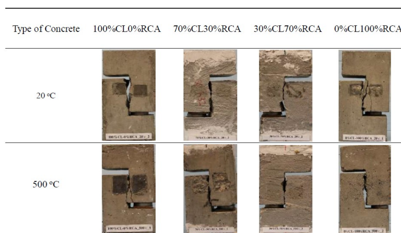
Figura 5.2-27: Modi di collasso dei provini
