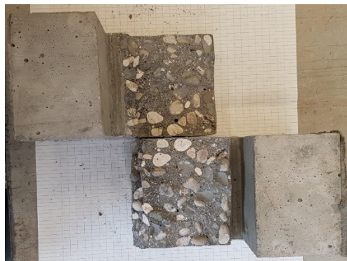
Figura 7.3-21: Superficie di frattura del provino shear3_REF
