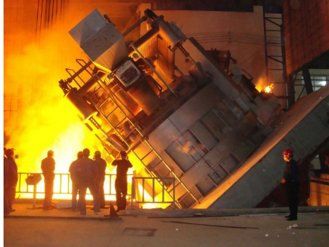
Figura 2.2-1: Forno elettrico ad arco durante le operazioni di colaggio
