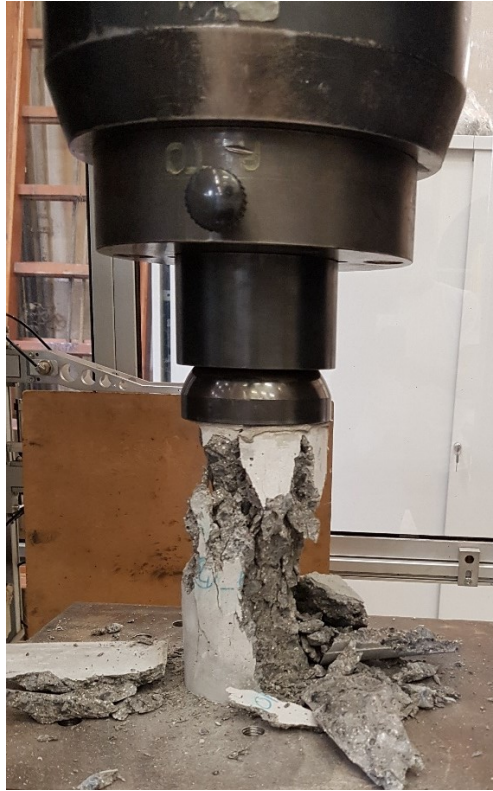
Figura 7.1-4: Configurazione di rottura del provino 4_EAF dopo la prova a compressione a 28 giorni
