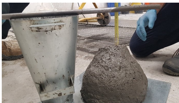
Figura 6.4-1: Esecuzione della prova di abbassamento al cono
