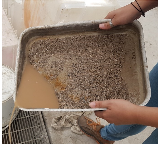
Figura 6.1-1: Fase di lavaggio della sabbia 0-4 mm
