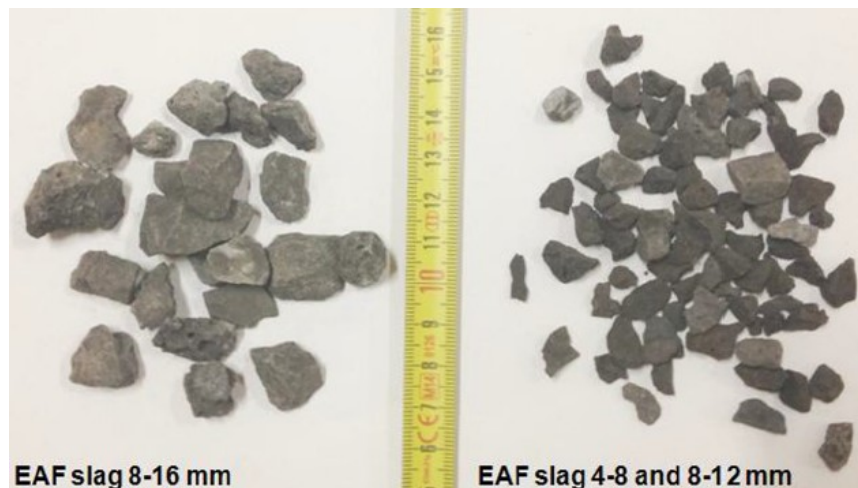
Figura 5.1-13: La scoria EAF nera utilizzata in questa ricerca
