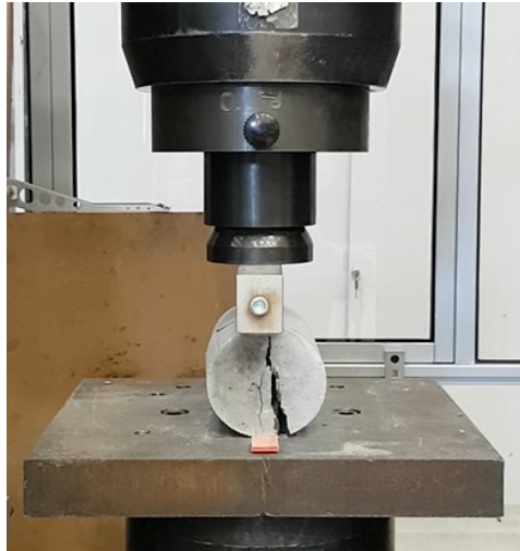
Figura 7.2-2: Configurazione di rottura del provino 6_REF dal fronte della macchina al termine dello splitting test
