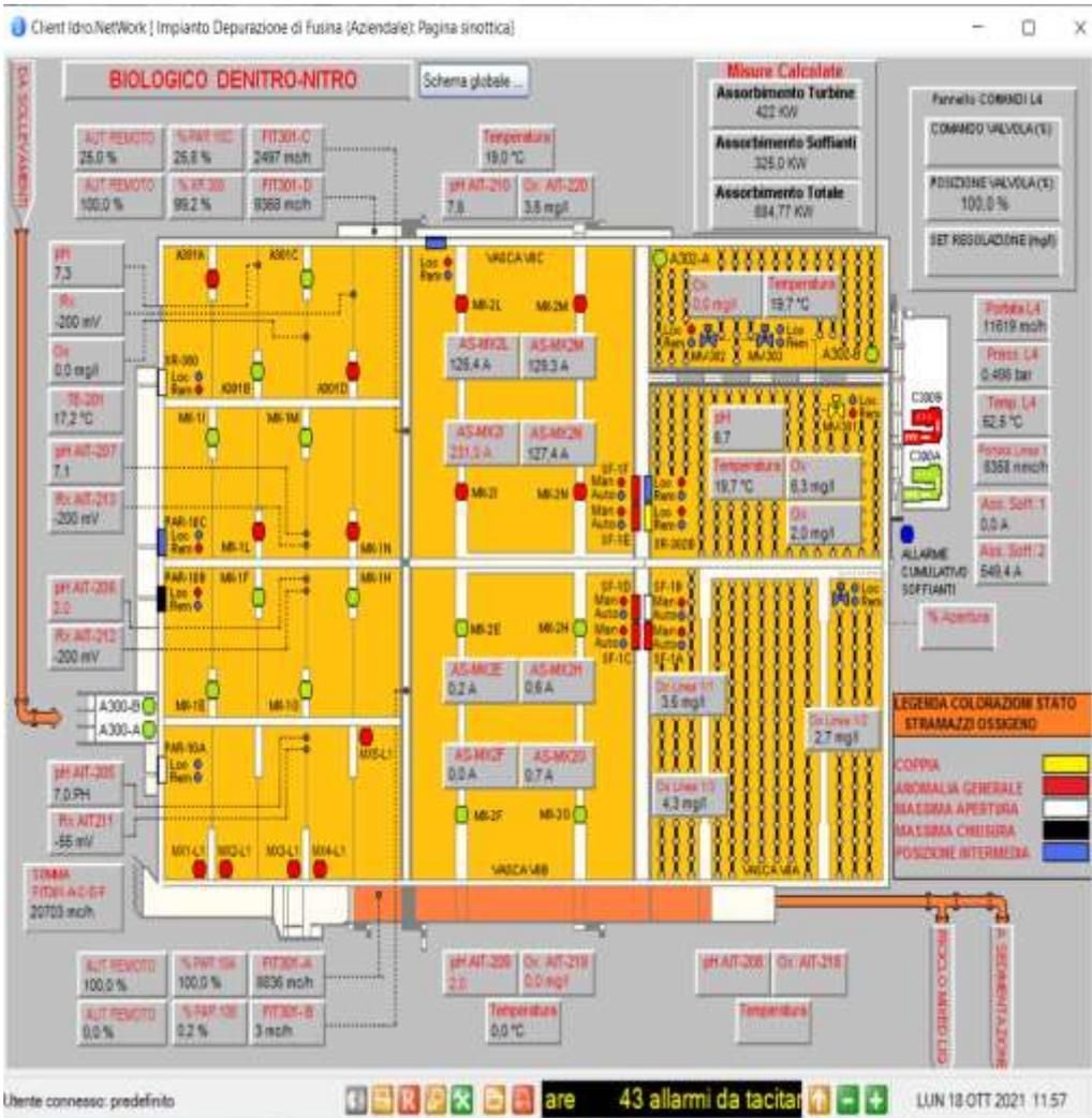
**Scopo della sezione:** demolizione della specie  $N-NO_3^-$ , proveniente principalmente dal ricircolo della miscela aerata dalla nitrificazione, utilizzando la sostanza organica presente nel liquame influente.
