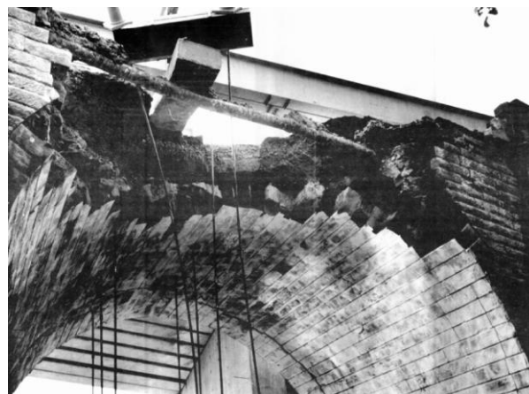
Figura 3.7 Bargower Bridge : prospetto (in alto a sinistra), sezione longitudinale e trasversale con le principali indicazioni geometriche (in alto a destra), fessurazione longitudinale preesistente nell'arcata (in basso a sinistra) e condizione a collasso (in basso a destra). [54]
