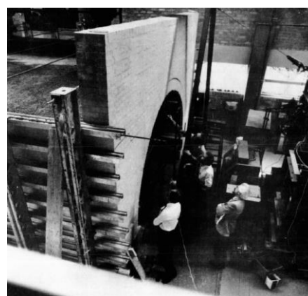
Figura 3.14 Dundee model : costruzione dell'arcata (a sinistra) e separazione tra arco e timpano nella fase finale di carico (a destra). [50]
