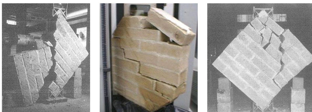
Figura 2.14 Meccanismi di collasso a taglio: fessurazione diagonale e ribaltamento di una metà del pannello [30]; scorrimento in corrispondenza dei giunti di malta [31]; scorrimento e ribaltamento di frammenti di pannello [30].
