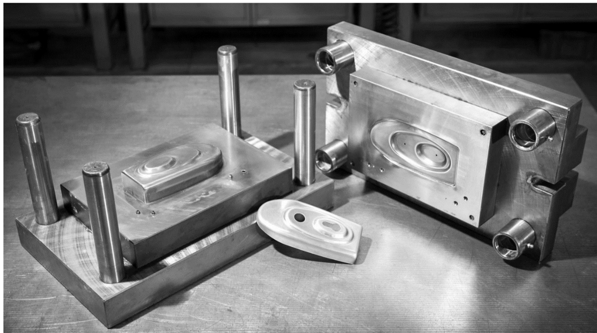
Figura 3.2 - Esempio stampo per imbutitura poco profonda [14]
