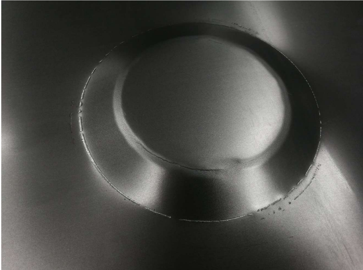
Figura 4.14 - Campione PDT senza cera dopo punzonatura
