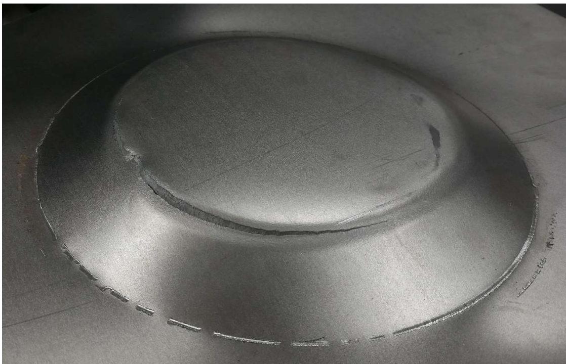
Figura 4.12 - Campione PDT con cera dopo punzonatura
