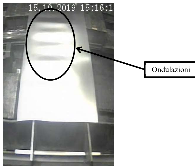
Figura 4.9 - Condizione che ha portato a rottura del nastro
