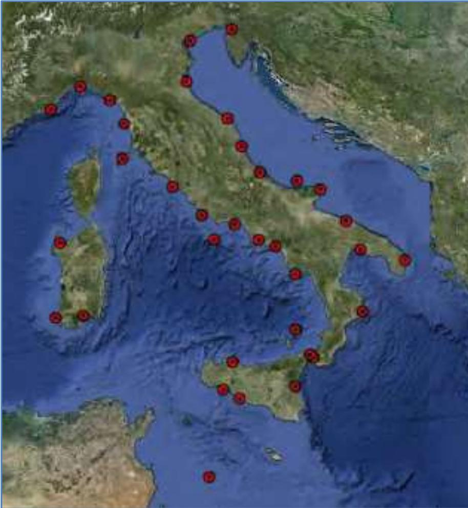
36 stazioni di osservazione in tempo reale (livello, pressione atm, velocità e direzione del vento, temperatura acqua).
