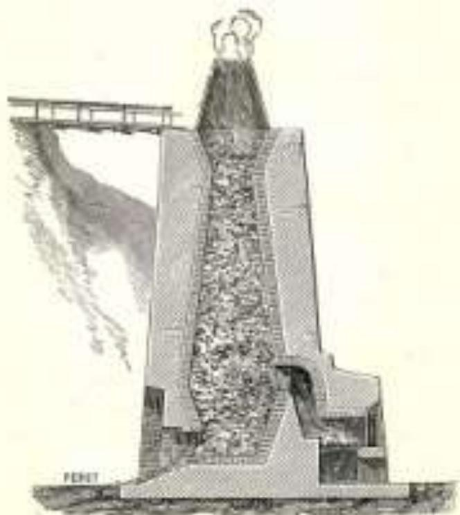
Fig. 28. — Four à chaux.
