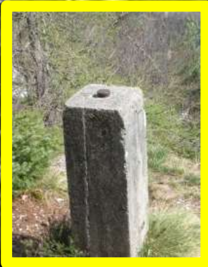
Due sostegni fissi per appoggio strumento, in sponda dx, distanti tra loro 1 km
