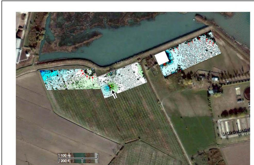
La freccia nera indica una estesa ed intensa anomalia magnetica le frecce rosse indicano anomalie di contenute dimensioni
