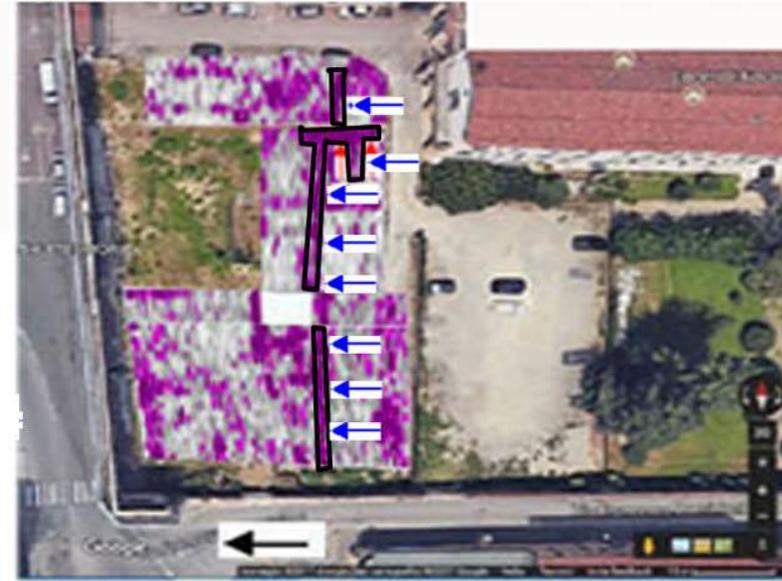
In entrambe le mappe le frecce blu indicano le strutture (muri e fondazioni) medievali localizzate a profondità compresa tra 0.5 m e 1.5 m. Le frecce nere indicano il verso di percorrenza dell'antenna del georadar.
