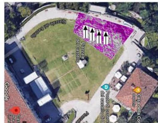
Le frecce nere indicano una condotta sepolta alla profondità di 0.65 m
