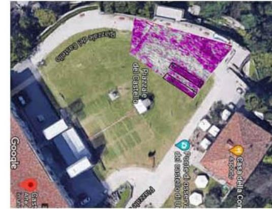
Sezione parallela alla superficie alla profondità di 1.0 m
