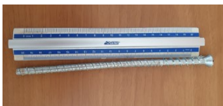
Fig. 2.1.7 Deformazione residua delle viti estratte dal campione R-3 (Giongo et al., 2021).
