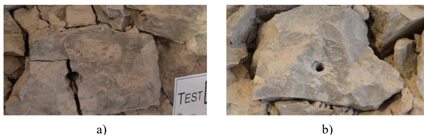
Fig. 1.4.13 Danneggiamento sperimentale osservato nella muratura in pietra: a) fessurazione a trazione, b) collasso del sistema per schiacciamento dei giunti di malta adiacenti al blocco (Riccadonna et al., 2019).
