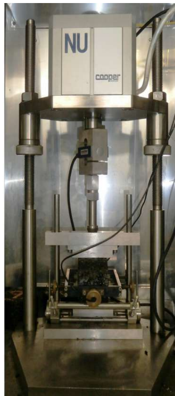
Figura 7.4: Strumentazione di laboratorio per test ITSM.
